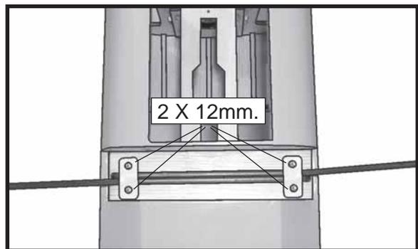
**INSTALLING ELECTRIC MOTOR.**
